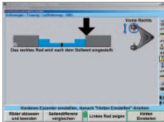
Abb: Einstellung vorderer Exzenter rechte Seite
