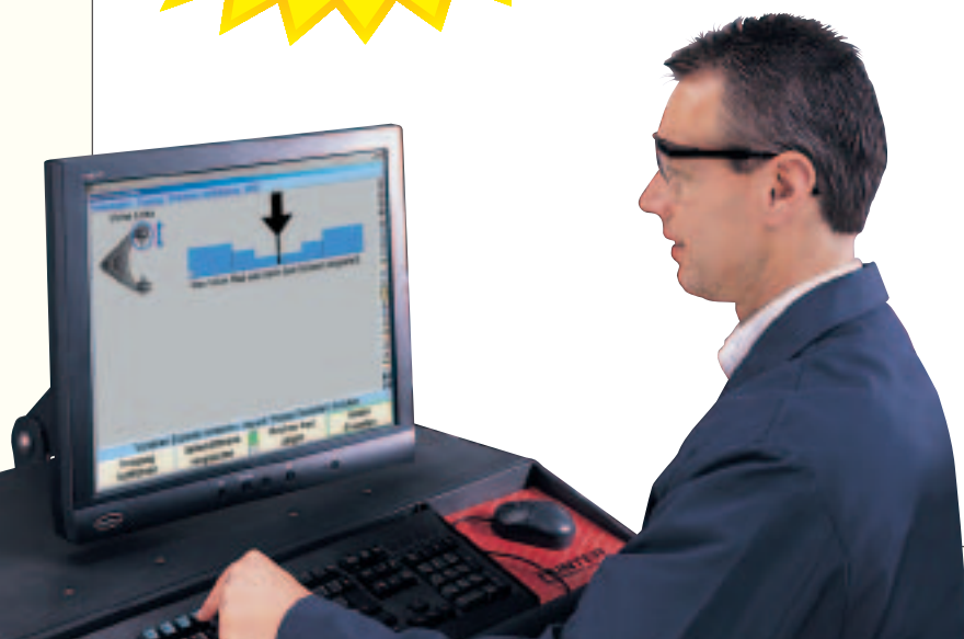
Abb: Einstellung vorderer Exzenter linke Seite mit Referenz der rechten Seite.
