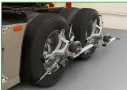
**1. Montieren der sechs Sensoren**
